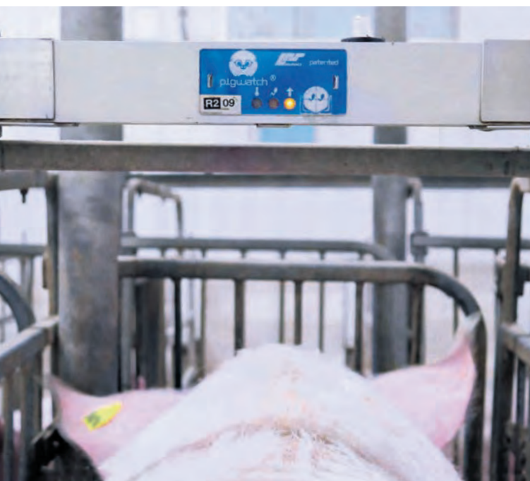
Vue d'une portion du système PigWatch installé au-dessus de la cage d'une truie (les capteurs de mouvements y sont intégrés).
