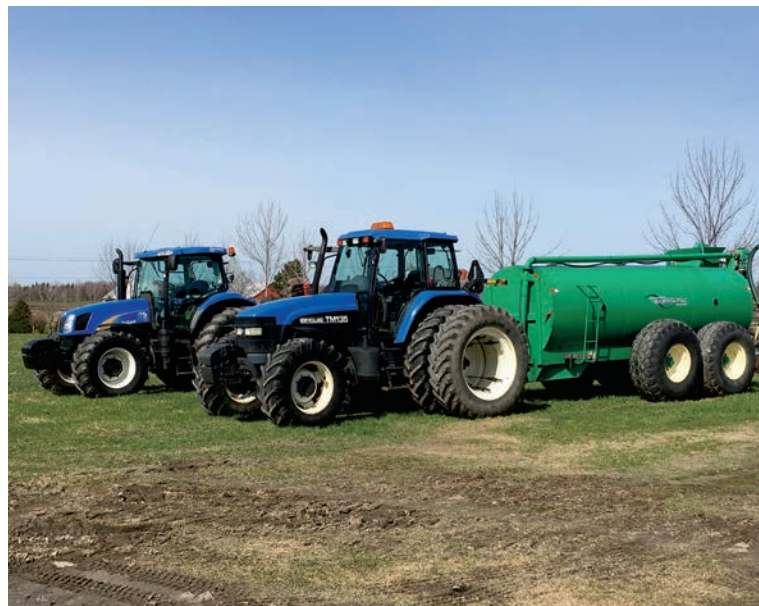
Jumelées à leurs autres bonnes pratiques de travail du sol, les Boucher utilisent des tracteurs à roues doubles pour réduire la compaction du sol.
