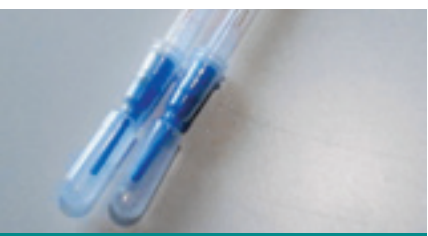
Figure 2. Écouvillons pour effectuer la collecte d'échantillons à analyser avec l'ATP-mètre
