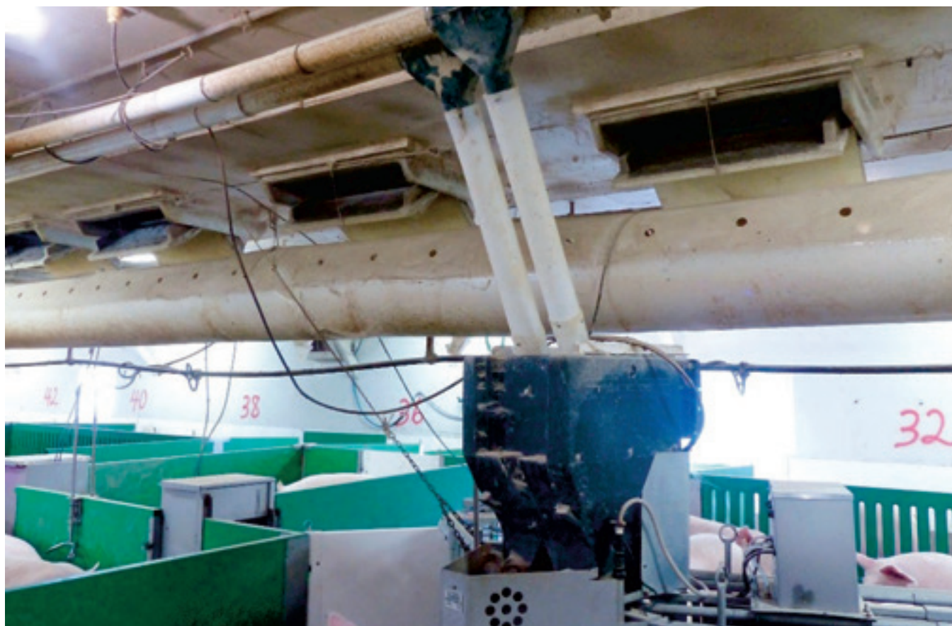
Photo 1 : Deux lignes de soigneurs installées dans l'entreprise Hog Tied Farms en Ontario, permettant la distribution de deux aliments différents en simultanée.
